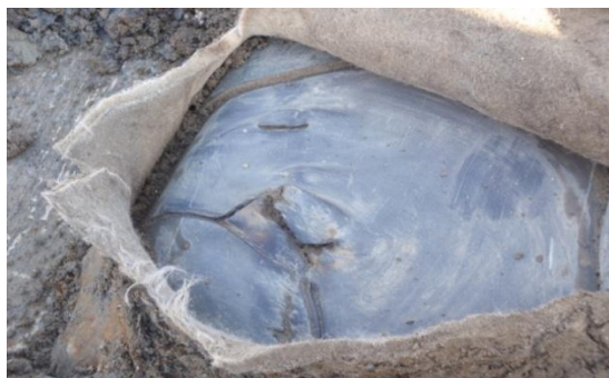
写真－2. 3 清掃後の破損箇所
