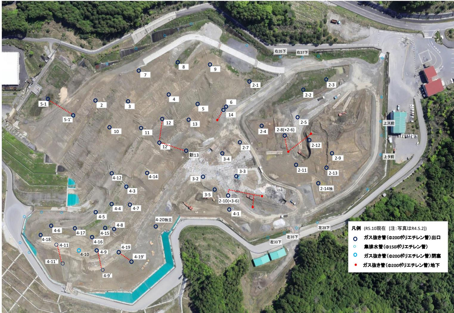
図1 測定地点ガス抜き管位置図
