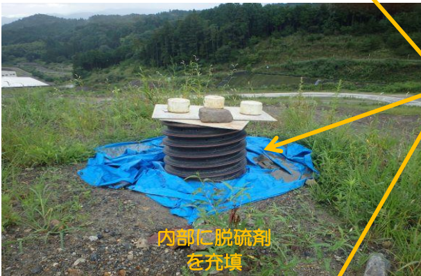
② 写真2 ポリエチレン管設置式
