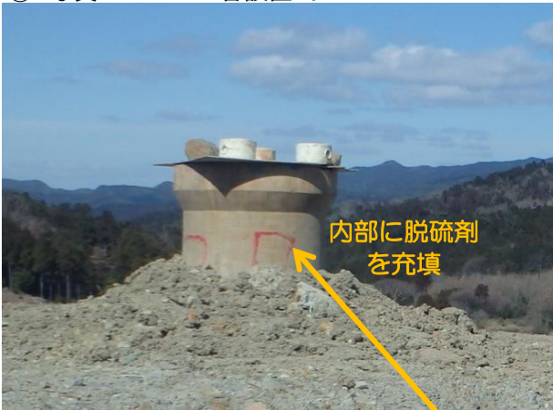
② 写真2 ポリエチレン管設置式
